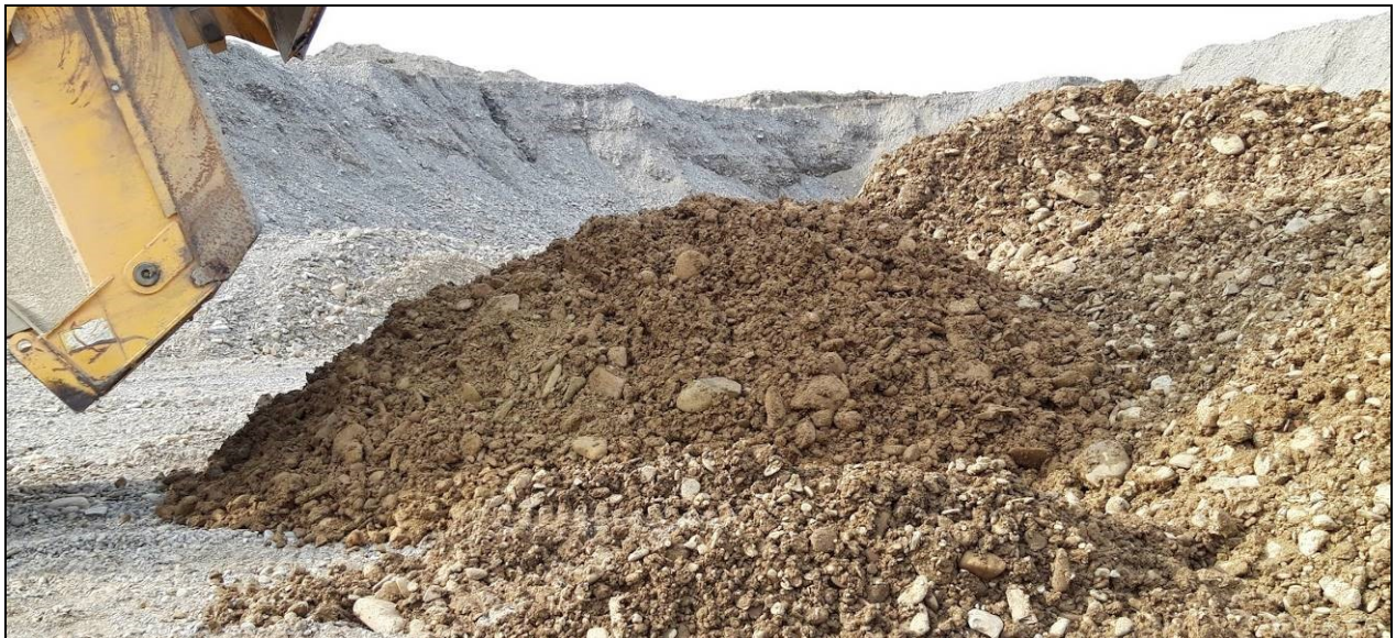
Figura 5: Sondaggio investigativo condotto con mezzo escavatore in cava Fornace 1 a quote comprese fra -15 m p.c. e -20 m p.c.: Giacimento caratterizzato da un'eccessiva matrice limo-argillosa giallo-ocra.
