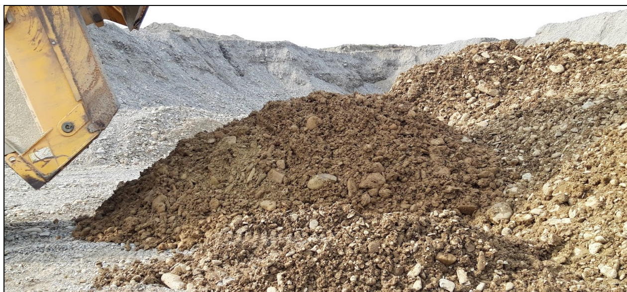
Figura 1: Sondaggio investigativo condotto con mezzo escavatore in cava Fornace 1 a quote comprese fra -15 m p.c. e -20 m p.c.: Giacimento caratterizzato da un'eccessiva matrice limo-argillosa giallo-ocra.
