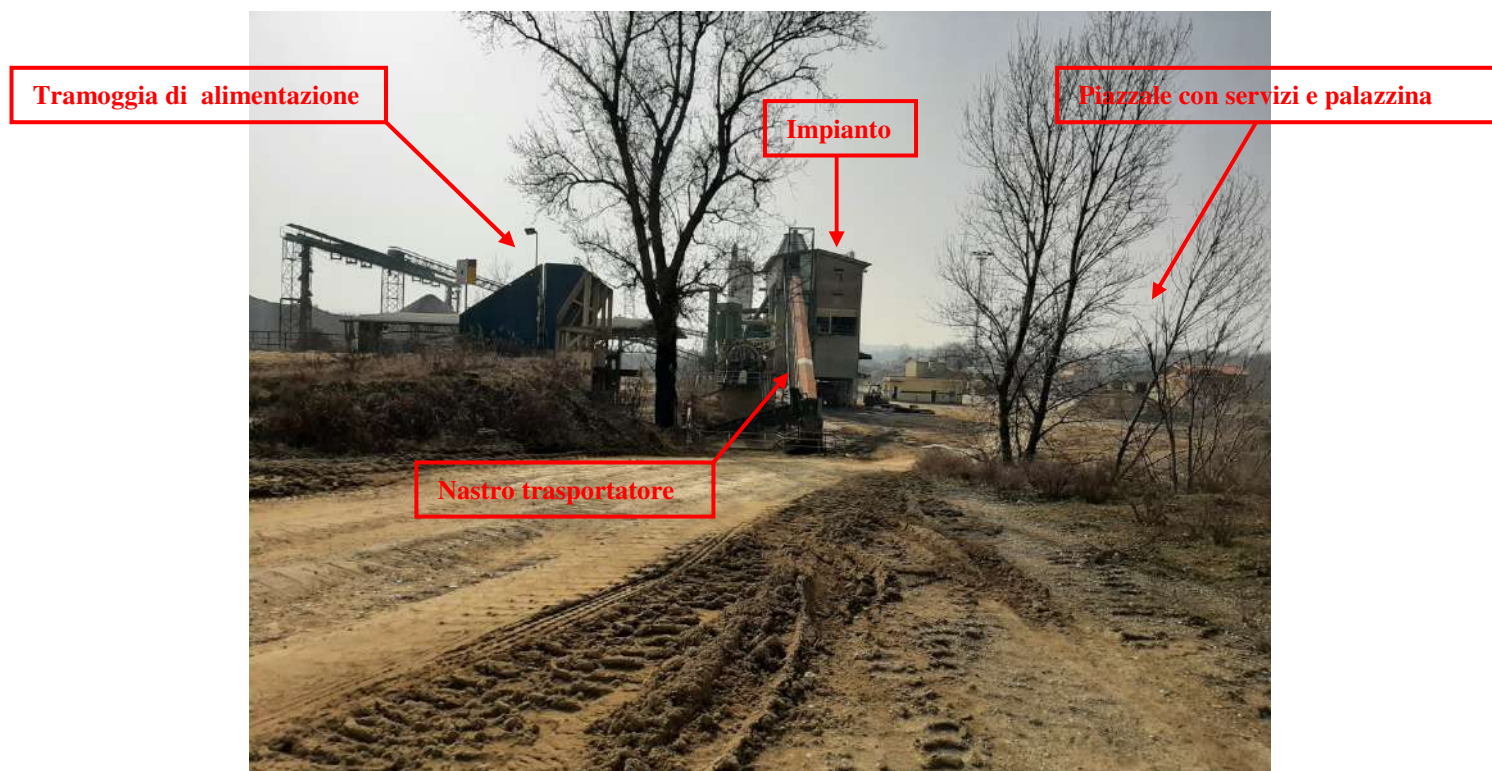
Foto n° 1a Vista frontale di impianto di frantumazione.
