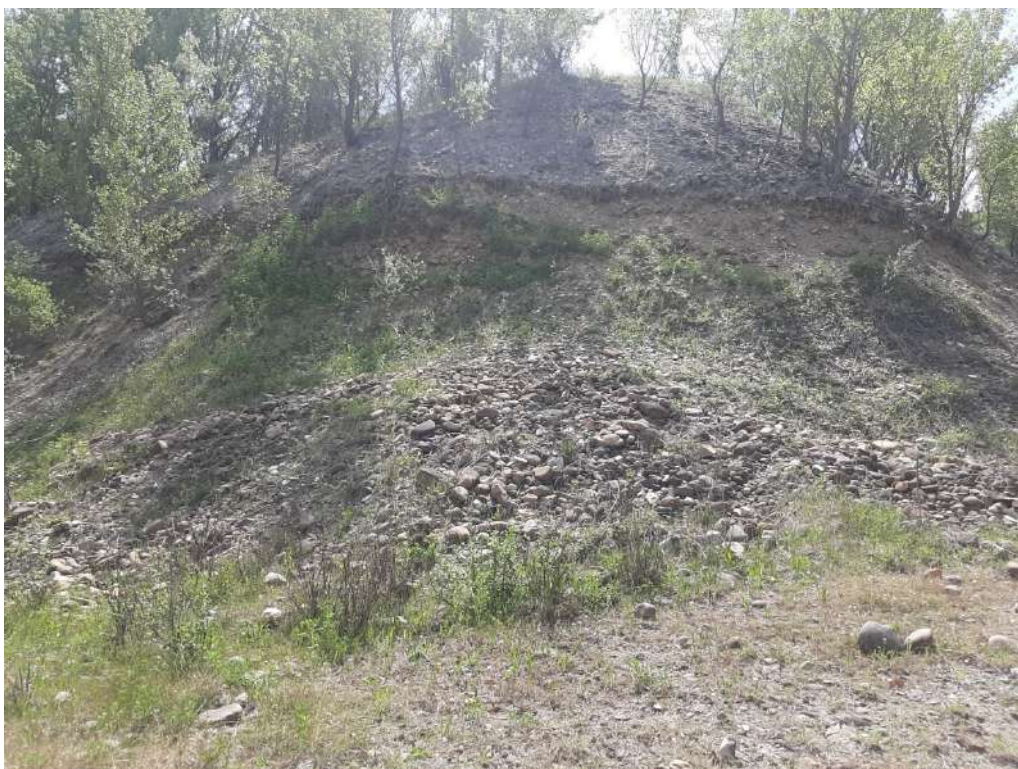
Foto n° 3e Vista particolare delle “ghiaie” produttive. Elementi arrotondati a diametro variabile sino a cm. 20.
