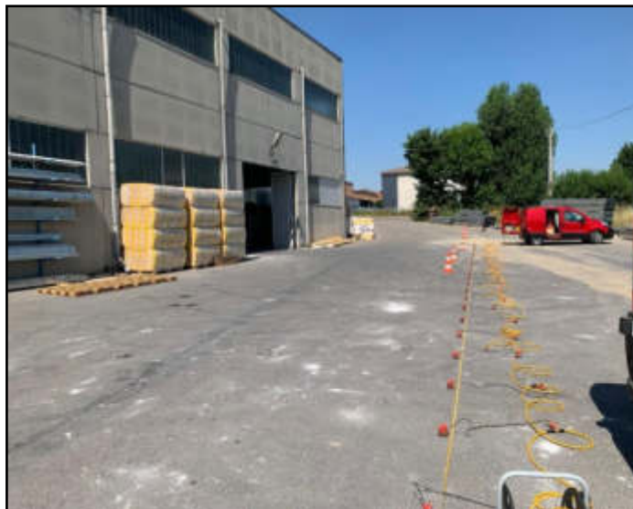
Figura 1: Vista dello stendimento MASW effettuato.
