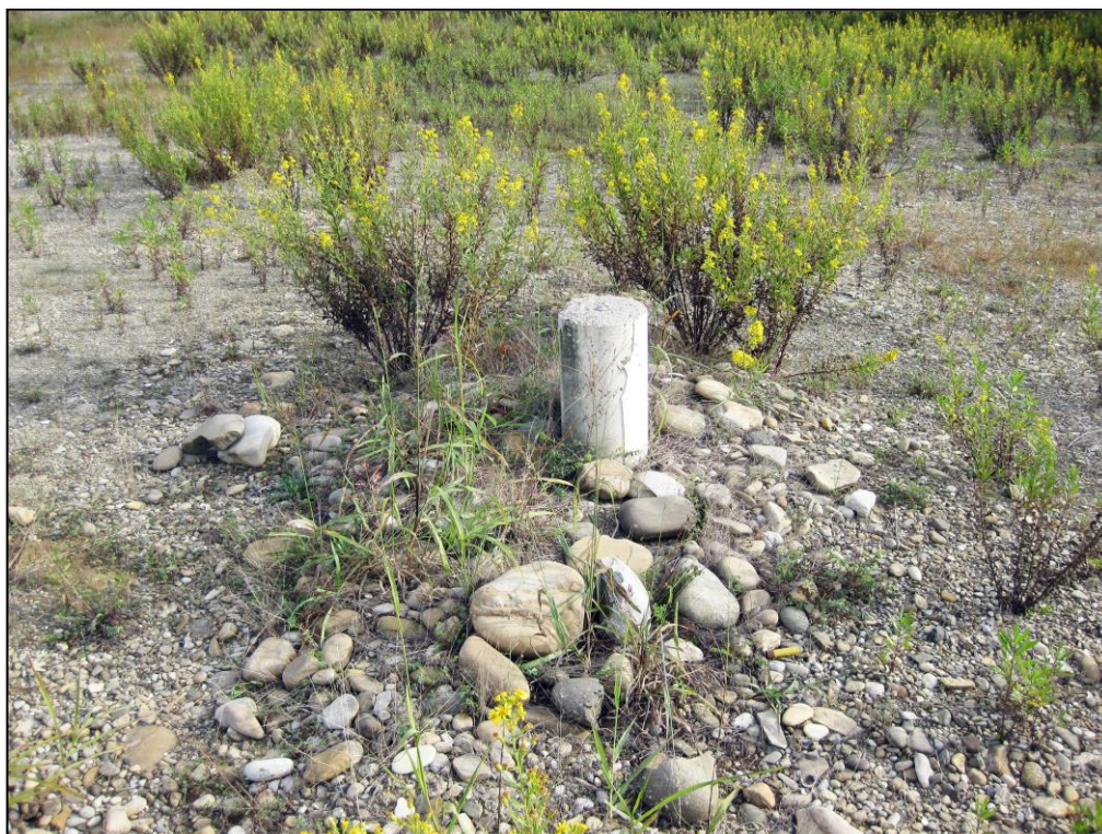
Figura 27 - Vista del caposaldo C3 posto all'interno della cava "San Lorenzo 2" sul fondo escavato a -10,00 m da p.c.
