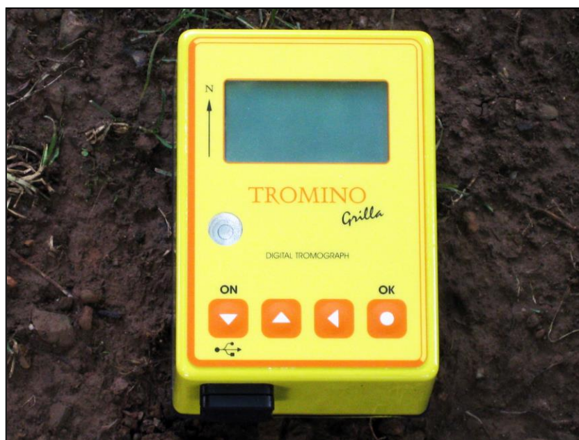
Figura 9 – Esecuzione di una registrazione del microtremore ambientale mediante TROMINO Zero.
