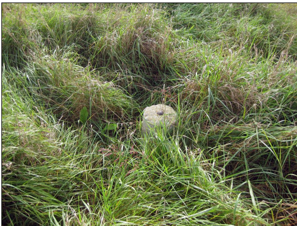
Figura 25 - Vista del caposaldo C2 posto all'interno della cava "San Lorenzo 2" alla sommità della fascia di rispetto di 20 m della canalina demaniale (rispetto già presente nella prima fase di escavazione fino a -10,00 m da p.c.).
