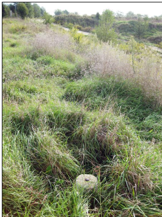
Figura 26 - Vista del caposaldo C2 posto all'interno della cava "San Lorenzo 2" alla sommità della fascia di rispetto di 20 m della canalina demaniale (rispetto già presente nella prima fase di escavazione fino a -10,00 m da p.c.); si nota sullo sfondo il buono stato vegetativo della scarpata est e l'ingresso del giacimento.
