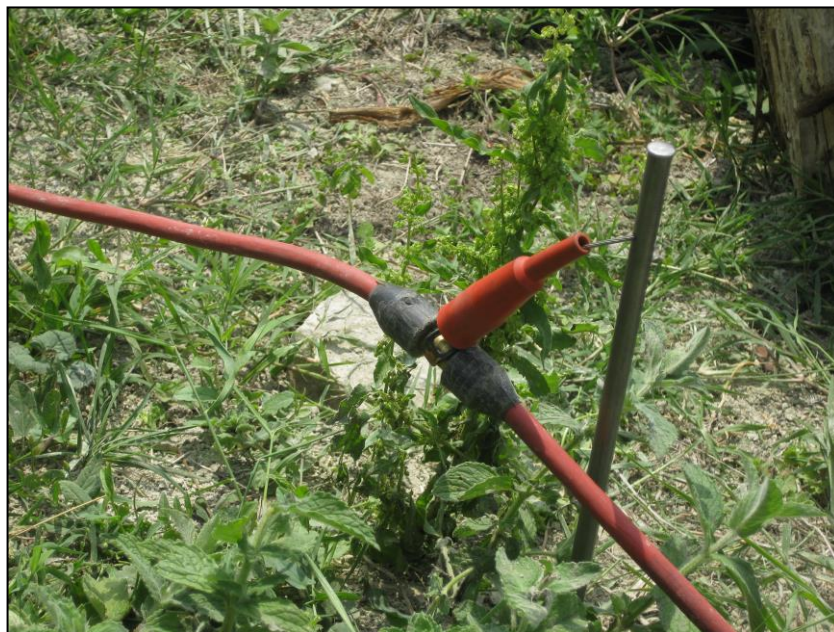
Figura 8 – Elettrodo utilizzato durante uno stendimento tomografico (ERT).
