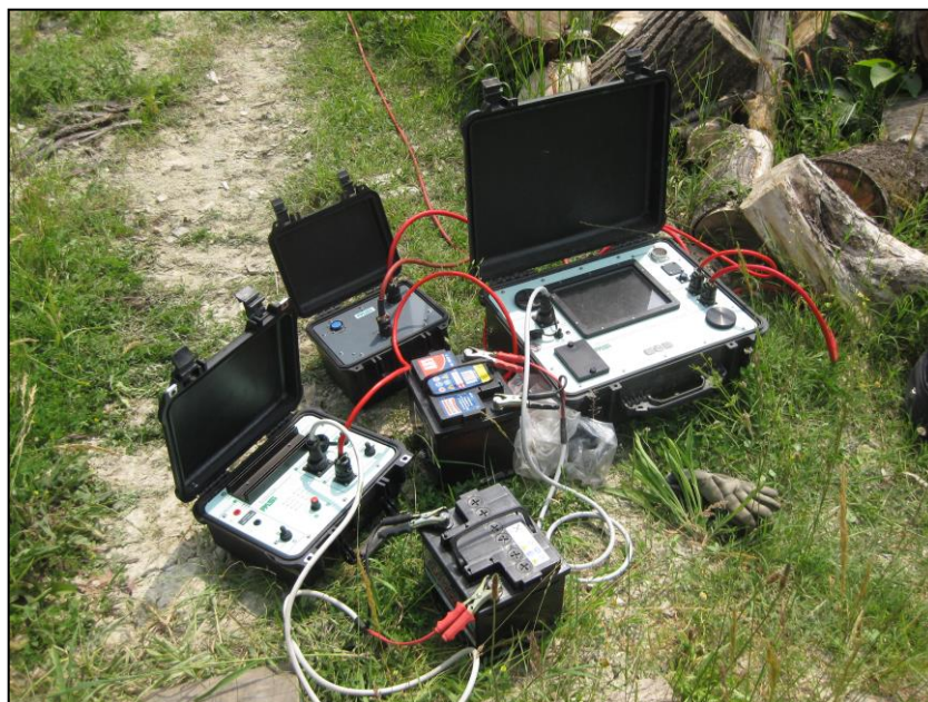
Figura 6 – Esecuzione di una prova tomografica (ERT) mediante PASI 32SG12.
