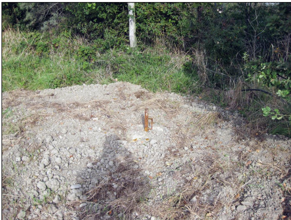
Figura 23 - Vista del caposaldo C1 posto all'interno della cava "San Lorenzo 2" al confine nord-ovest.
