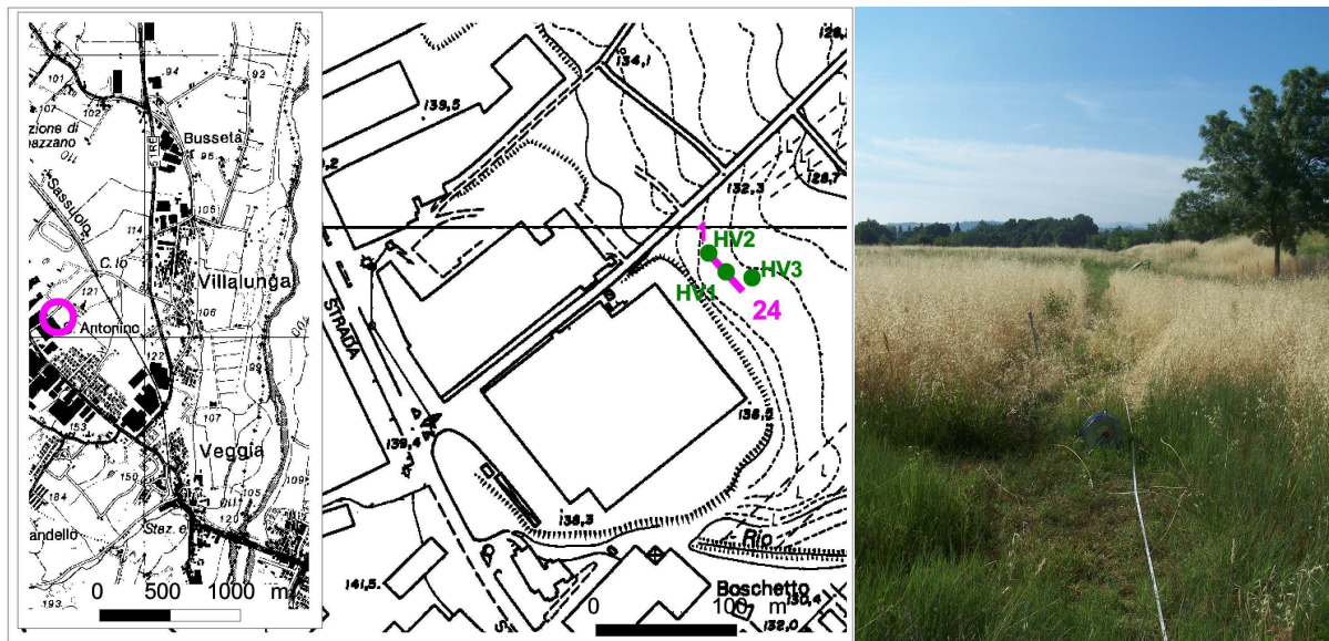
Figura 1. A sinistra: Estratto da CTR con ubicazione dello stendimento MASW (linea in magenta: i numeri 1 e 24 identificano i geofoni esterni) e delle acquisizioni a stazione singola HVSR (punti in verde). A destra: stendimento sismico MASW eseguito a Casalgrande (Via F. Turati)
