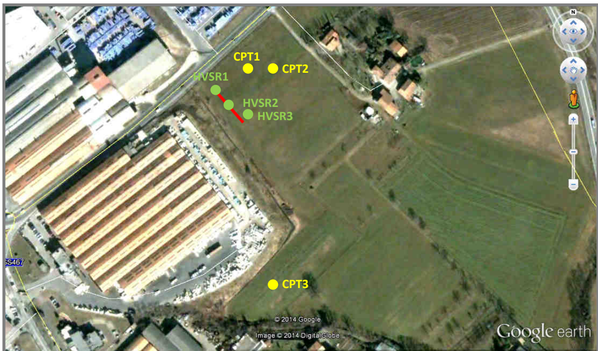
Figura 4. Ubicazione delle prove penetrometriche statiche effettuate (in giallo), dello stendimento MASW (in rosso), delle misurazioni di rumore sismico ambientale (HVSr 1-3, in verde). Foto tratta da Google Earth, immagine Digital Globe acquisita in data 04/05/2003.
