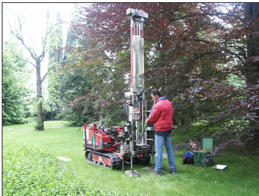
Figura 7 – Esecuzione di una prova penetrometrica statica/dinamica con penetrometro Pagani TG 63/200 da 20 ton.
