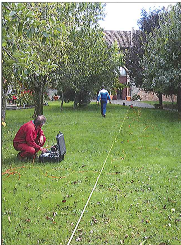
Figura 3 – Esecuzione di una prova sismica a rifrazione con elaborazione MASW mediante sismografo PASI a 24 canali.
