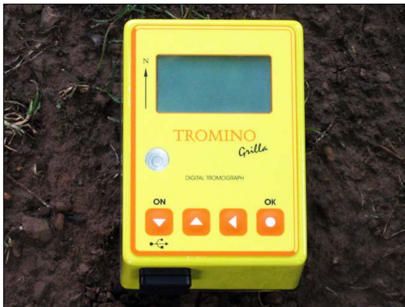
Figura 9 – Esecuzione di una registrazione del microtremore ambientale mediante TROMINO Zero.
