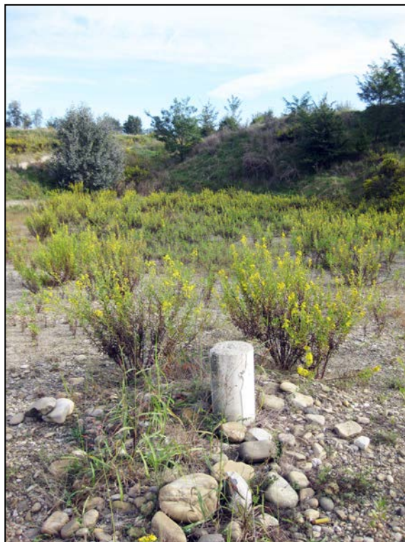
Figura 28 - Vista del caposaldo C3 posto all'interno della cava "San Lorenzo 2" sul fondo escavato a -10,00 m da p.c.; si nota sullo sfondo il buono stato vegetativo della scarpata est e l'ingresso del giacimento.
