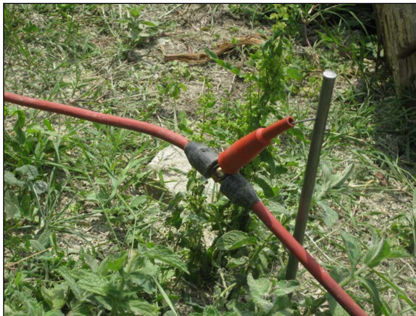
Figura 8 – Elettrodo utilizzato durante uno stendimento tomografico (ERT).
