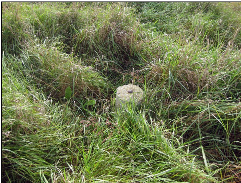
Figura 25 - Vista del caposaldo C2 posto all'interno della cava "San Lorenzo 2" alla sommità della fascia di rispetto di 20 m della canalina demaniale (rispetto già presente nella prima fase di escavazione fino a -10,00 m da p.c.).
