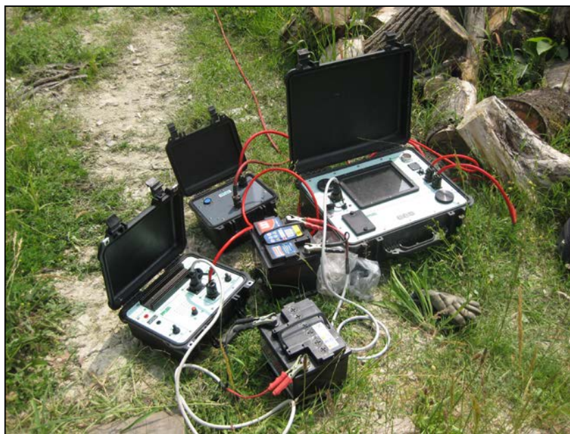
Figura 6 – Esecuzione di una prova tomografica (ERT) mediante PASI 32SG12.
