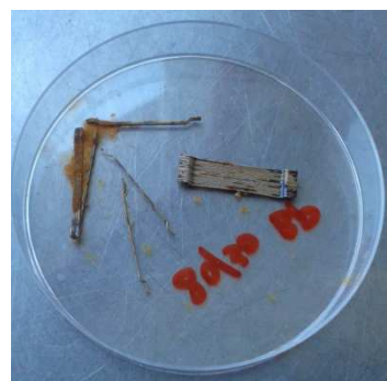
Fibre corrodibili, prova non superata
