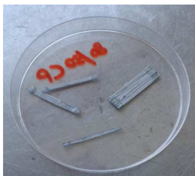
Fibre anticorrosione, prova superata
