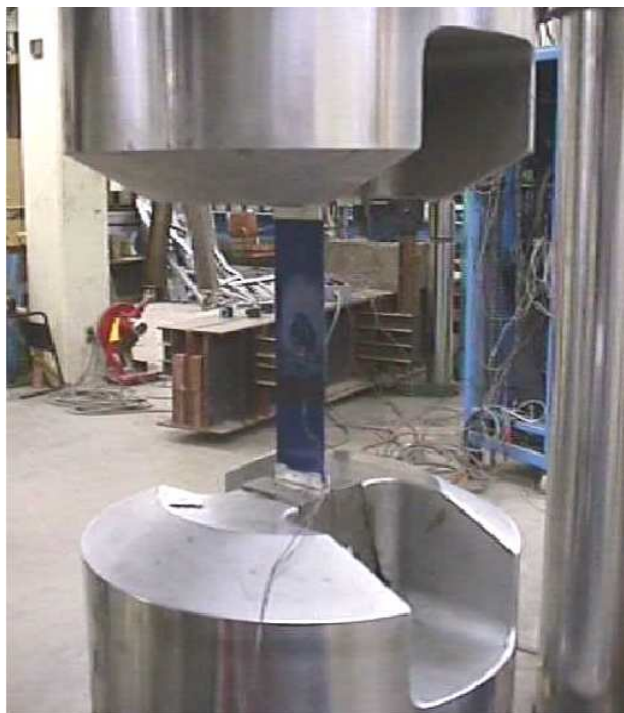
Esecuzione del test secondo ASTM D3039
