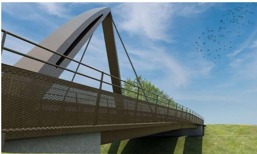
IMG.16 - Stato di progetto – fotoinserimento dettaglio parapetto passerella ciclopedonale da nord-ovest
