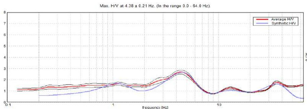
Estendendo il ragionamento a tutti gli strati ed eseguendo l'inversione della velocità con ricostruzione teorica del grafico delle frequenze si ottiene la seguente interpretazione stratigrafica:
