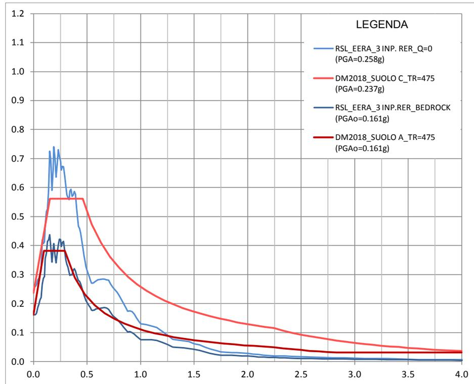
Per il calcolo dello spettro in accelerazione e delle amplificazioni sismiche, si sono seguite le direttive e le normative RER, utilizzando i 3 input sismici forniti dalla regione.
