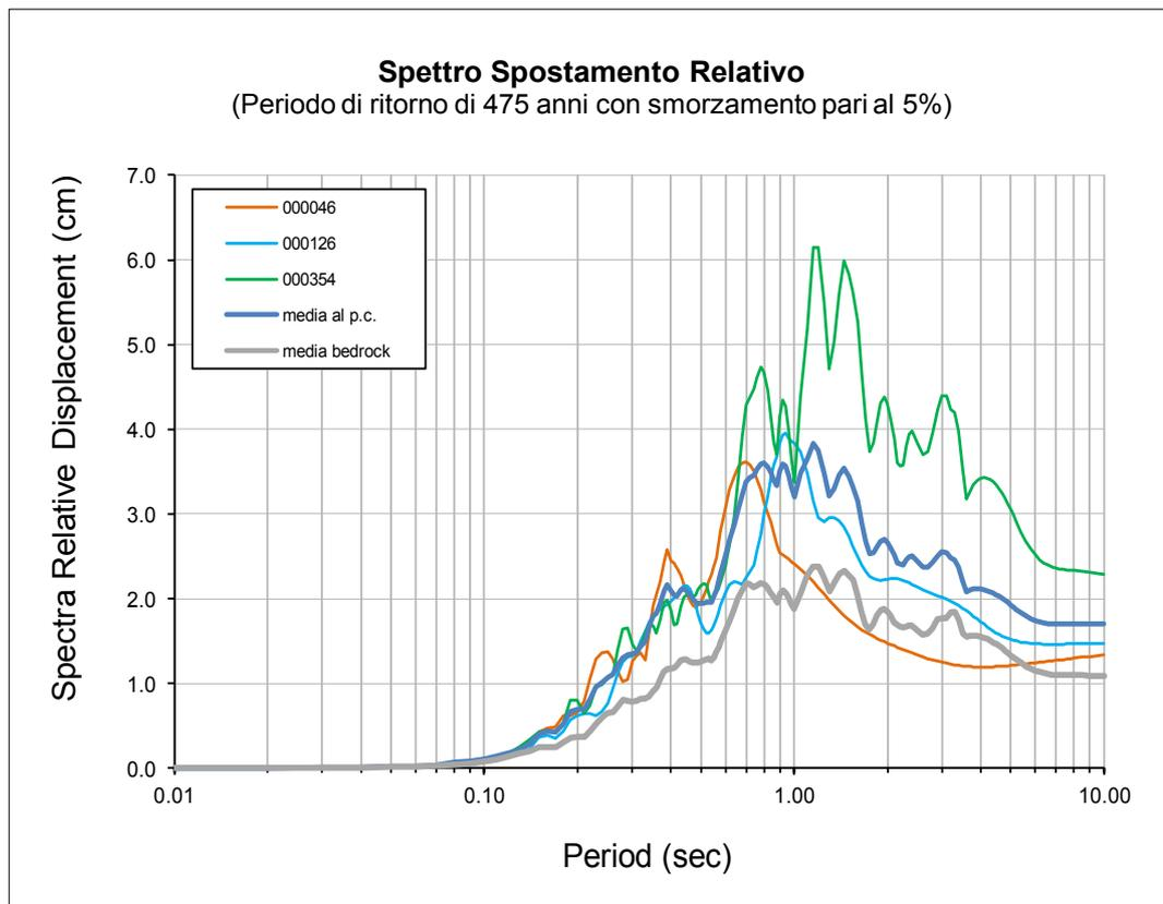
Dagli spettri in accelerazione (primo grafico) si ottiene subito il fattore di amplificazione PGA/PGAo e per integrazione dello spettro in accelerazione, per prefissati periodo di tempo, le nuove amplificazioni richieste dalla delibera regionale DGR 630/2019:
