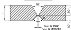
SALDATURE TRASVERSALI DI TESTA
