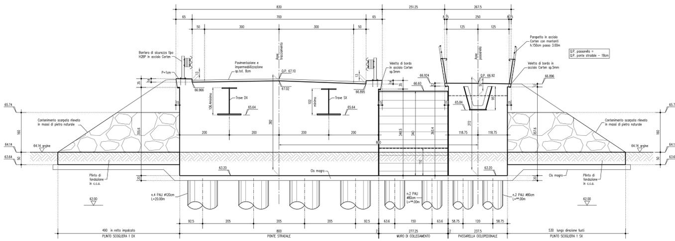
SEZIONE TRASVERSALE SCHEMATICA A TERGO SPALLE 1:100
