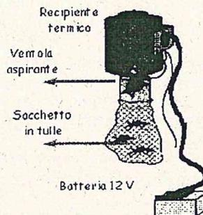
La quantità di ghiaccio secco necessaria per il funzionamento di 12 ore è di circa 500 g. Il ghiaccio secco da riporre nel serbatoio va avvolto in un foglio di giornale, per garantire una lenta sublimazione. La trappola va posizionata, nella stazione fissa individuata, nel pomeriggio (ore 17-19) e ritirata la mattina successiva. Va collocata in un luogo ombreggiato, appesa ad un supporto (ad es. un ramo) ad un'altezza di circa 1,5 m dal suolo.
