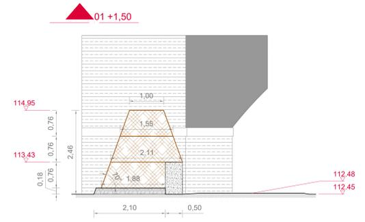
**A - Sezioni rilevato con terre armate**
